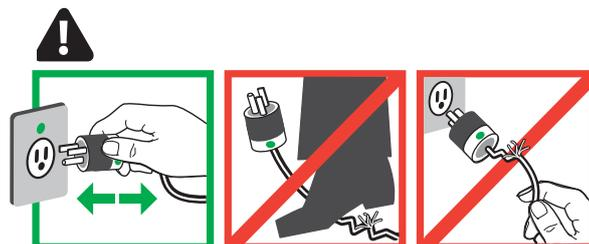
**DANGER!** Les câbles électriques peuvent être dangereux. Une mauvaise utilisation peut entraîner un incendie ou la mort par électrocution.
