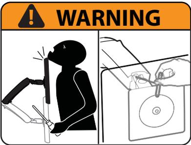
警告：蓄積エネルギーの危険：アームメカニズムには張力が作用しており、付属機器を取り外すと自動的に素早く上に跳ね上がります。そのため、付属機器を取り外す前にアームが一番上の位置に移動してください。この指示を無視すると、重大な人体への傷害や機器の損傷を招く恐れがあります。
