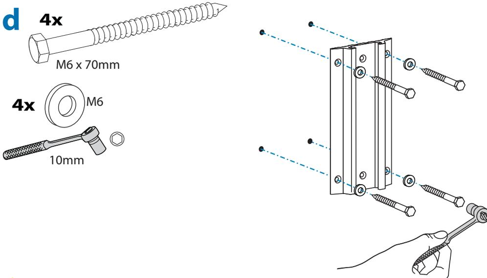
**注意:** ウォール マウント ブラケットが水平かつ平坦になり、壁の表面に密着するようにしてください。ボルトを締めすぎないように注意してください。
