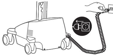
**c** Mettre le matériel hors tension en gardant enfoncé le bouton « AC Outlet Power » pendant 1 à 3 secondes. Le voyant d'alimentation s'éteindra.
